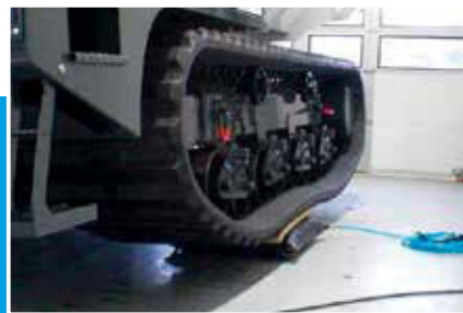
Anheben für einen Kettenwechsel - Maschinenbau -
