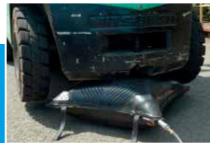
Anheben eines Gabelstaplers - Wartung -
