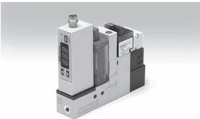
Der Sensor "V2" hat 2 unabhängige NPN- oder PNP-Ausgänge für die Vakuumbestätigung. Typische Reaktionszeiten für die Ausgänge in einem durchschnittlichen Schaltkreis liegen unter 50 ms. Die Ausgangsreaktionszeit des Sensors selbst liegt unter 2 ms.
