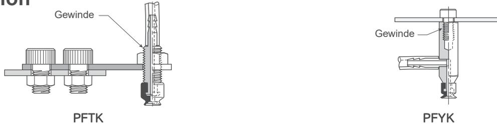
**Hinweis:** Bei Installation von montagefertigen Saugern ist ein geeignetes Dichtungsmaterial zu verwenden.
