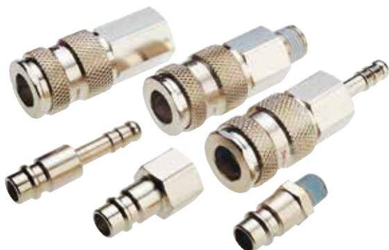
Einseitig absperrend. Beim Lösen der Verbindung schliesst die Kupplung sofort, der Stecker hat weiterhin freien Durchgang. Ideal für den Einsatz mit einfachen Druckluftwerkzeugen oder ähnlichem
